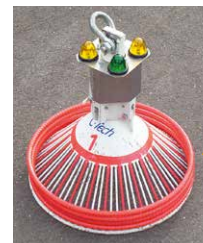
ヘリ側の鉄塔吊上げ治具
