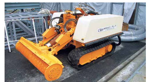
水中排砂ロボット本体
