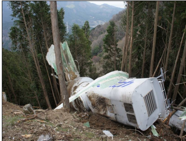
写真 1 タワー座屈・ブレード・ナセル脱落状況
