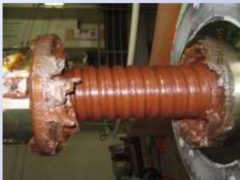
運開後15年で損傷したボールネジの状況
