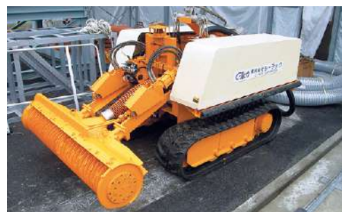
水中排砂ロボット本体
